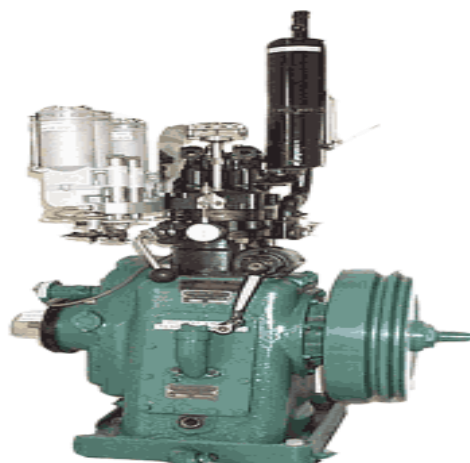
ภาพที่ 5.2 แสดงเครื่องยนต์ CFR (Cooperative Fuels Research) สูบเดียว (ที่มา : http://www.runyard.org )
