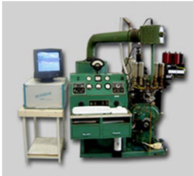
ภาพที่ 5.18 แสดงการทดสอบหาค่าซีเทนนัมเบอร์กับเครื่องยนต์ CFR (ที่มา : http://www.vcharkarn.com )
